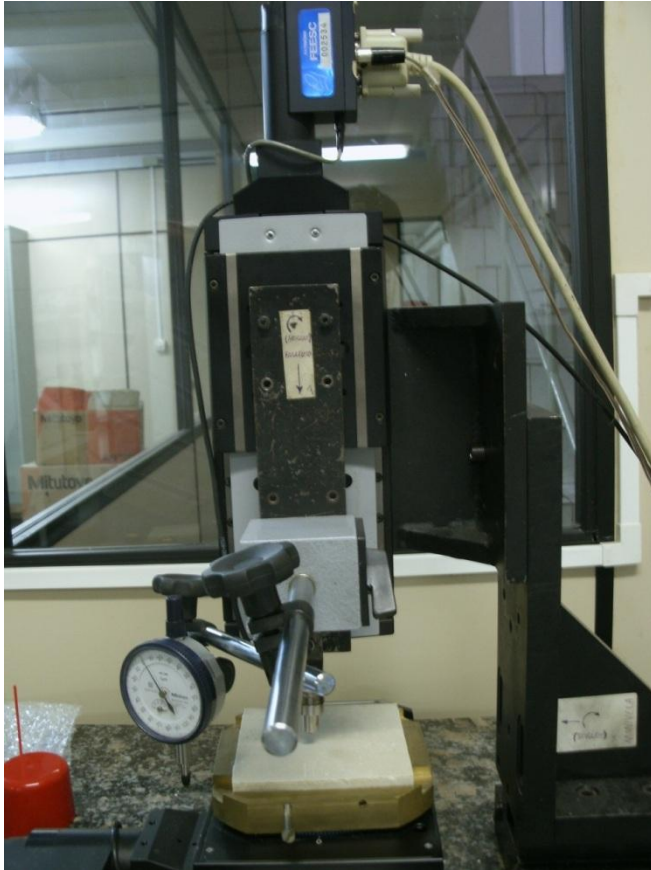
Figura 35 - Esclerômetro com relógio comparador para determinação de planos em amostras
