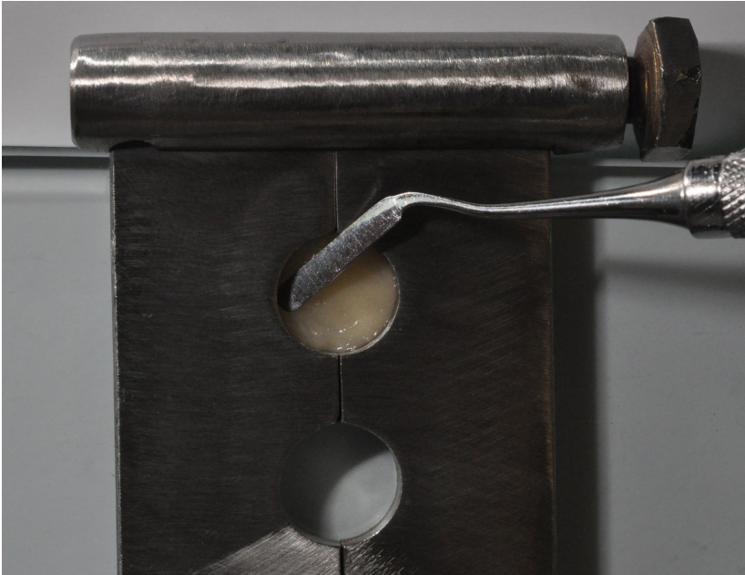
Figura 10: Inserção da resina Z250 com espátula Suprafil.
