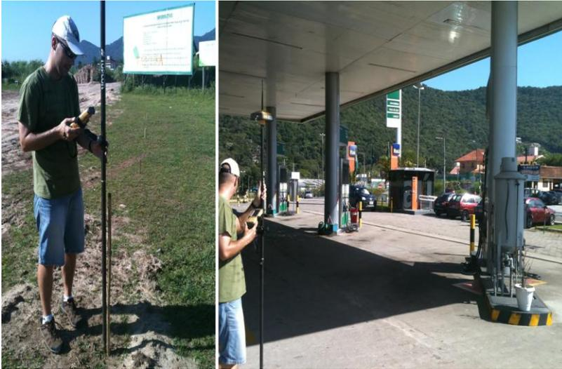
**Figura 46 – Início do trabalho com a coleta de dados no primeiro ponto da “linha de produção” e a medição debaixo da estrutura do posto de gasolina, que simula a condição da ÁREA 2 (Figura 40).**
