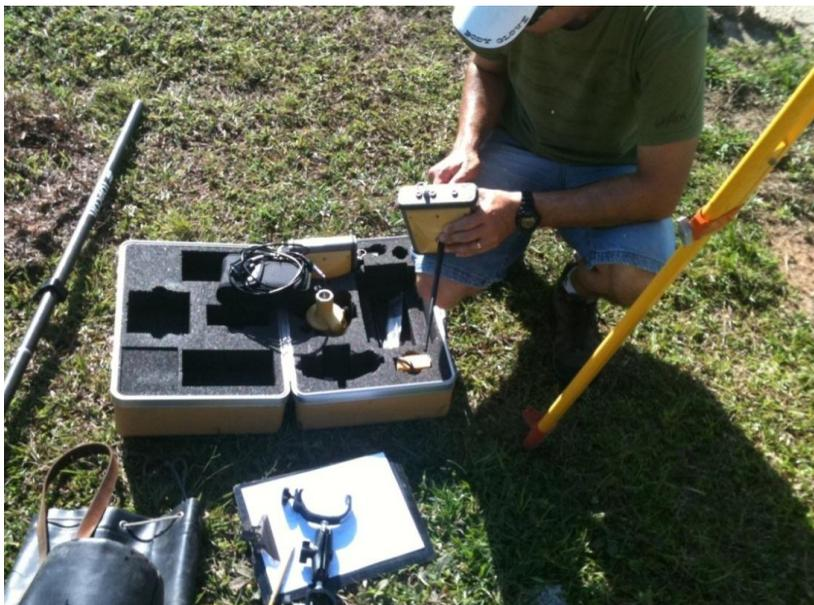
**Figura 42 – Montagem do equipamento RTK para medições em céu aberto.**
