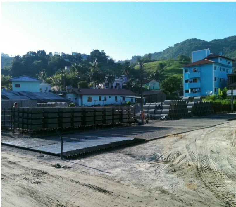
**Figura 77 – Armazenagem de blocos para secagem. Ao fundo blocos esperando caminhão para entrega aos clientes logo pela manhã.**
