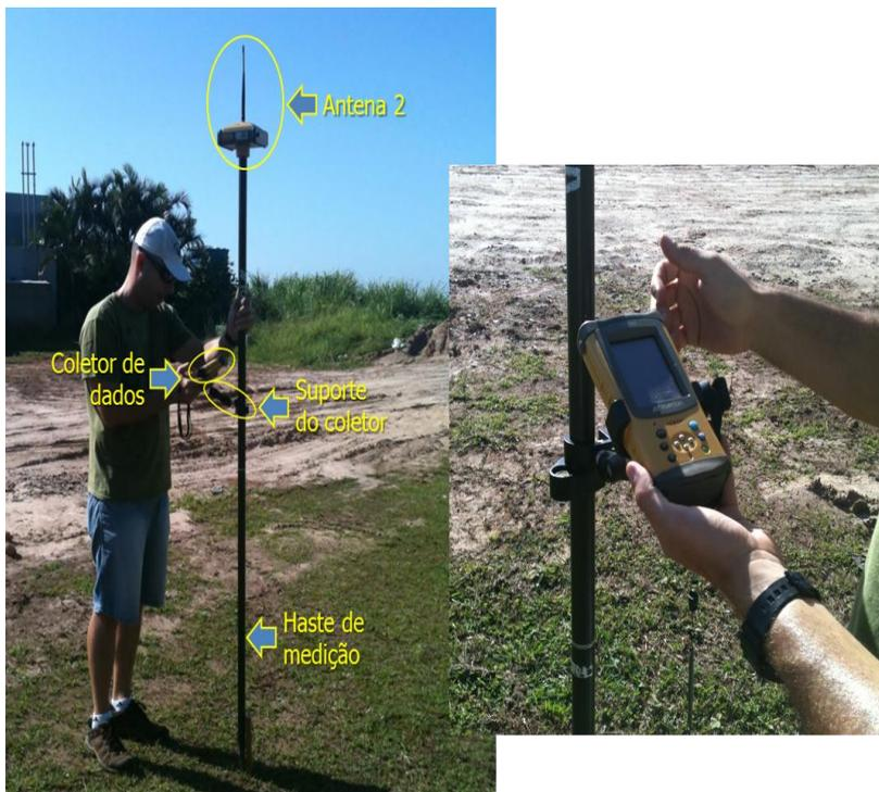
**Figura 44 – Equipamento para coleta de dados: haste de medição, coletor de dados RTK e antena 2.**
