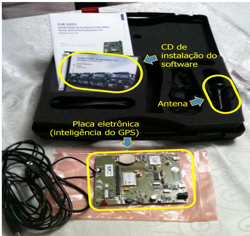
**Figura 37 – Kit GSM+GPS para demonstração do *chip* eletrônico utilizado para fabricação de equipamentos de GPS.**
