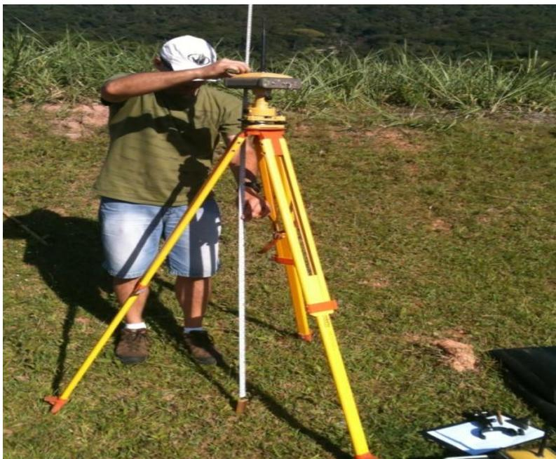
**Figura 43 – Montagem da antena 1 no tripé.**
