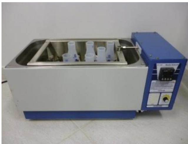
**Figura 12** – Banho termostático utilizado nos experimentos isotérmicos e cinéticos em batelada
