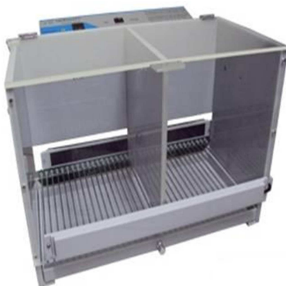
Figura 5 – Modelo representativo da caixa de esquiva ativa. Esta caixa foi modificada e utilizada nos experimentos do condicionamento aversivo contextual.
