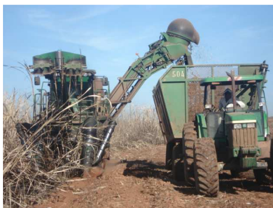
Figura 10. Trator acoplado ao transbordo alinhado com a colhedora na operação de colheita mecanizada.
