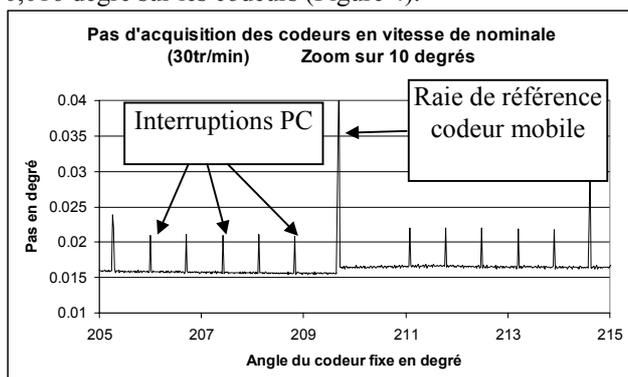
Figure 4 : Pas d'acquisition du système de mesure
