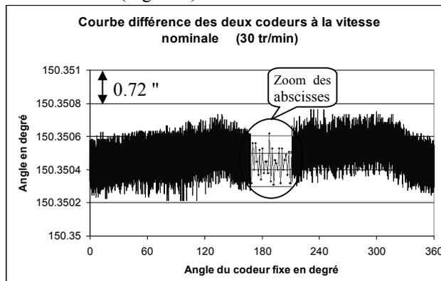
Figure 5 : Sous échantillonnage des lectures codeurs
