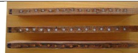
Aço galvanizado a frio (acima); aço galvanizado a quente (ao centro); aço carbono (abaixo)
