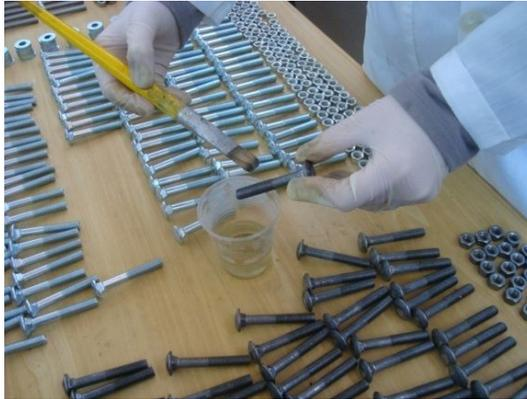
Figura 19 – Limpeza dos elementos metálicos pré-ensaios
