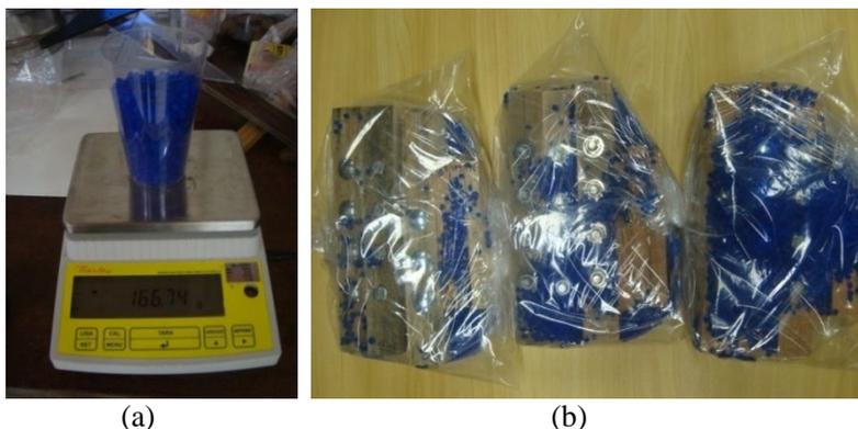
Figura 30 – Corpos de prova de controle contendo sílica gel
