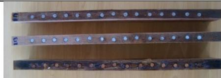
Aço galvanizado a frio (acima); aço galvanizado a quente (ao centro); aço carbono (abaixo)
