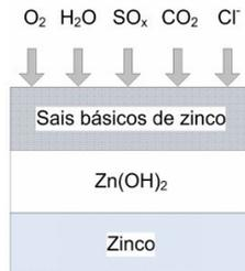
Figura 15 – Produtos de corrosão formados sobre o zinco durante a exposição à atmosfera. Fonte: Pannoni [19--]
