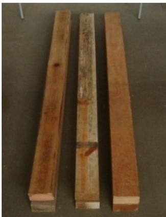
Figura 23 – Peças de madeira utilizadas na confecção dos corpos de prova.
