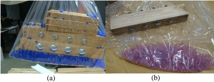
Figura 31 – Alteração de cor da sílica gel.
