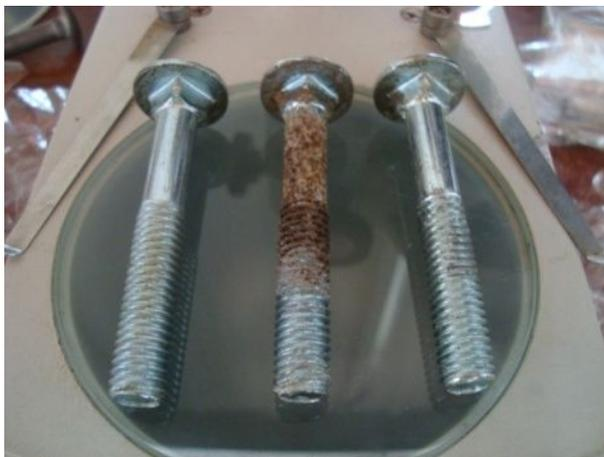
Figura 41 – Parafusos de aço galvanizado a frio embutidos nas três espécies de madeira aos 30 dias de ensaio. *Hymenolobium* (E), *Eucalyptus* (C) e *Pinus* (D)
