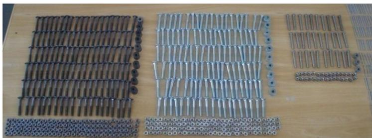
Figura 18 – Conjuntos de parafusos após limpeza mecânica: aço carbono. (E), aço galvanizado a frio (C) e aço inoxidável (D)
