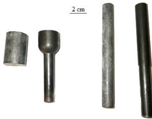
Figure 2 : Lopin et l'éprouvette forgée, pour les deux lots. A gauche : 75% de réduction de section. A droite : 18% de réduction de section. Les têtes des éprouvettes n'ont pas encore été usinées. Crédit photo : Société Gévelot Extrusion.
