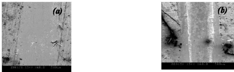
Figure 2 : Observation au MEB des traces de frottement (a) facies du cupro-plomb, (b) facies de l'alliage de Ni.
