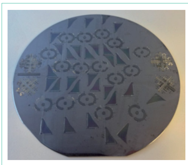
Figure 22 – Plusieurs thorax en SU-8 sur un substrat de silicium de 3 pouces, dont un sans membrane
