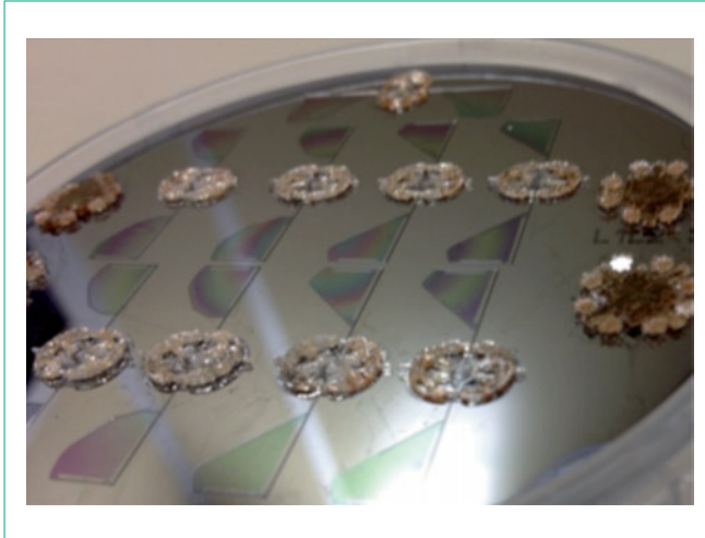
Figure 9 – Exemple de prototypes réalisés en SU-8 par photolithographie sur un wafer en silicium avant l'étape finale de libération
