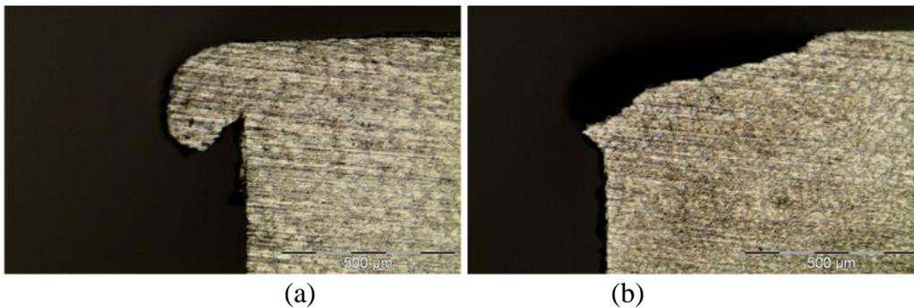
**Figure 3 : Micrographies présentant : (a) une bavure de type positive ( $\gamma = -5^\circ$  ;  $h = 0,05$  mm ; Lub : Sec ;  $R_\beta : 6 \mu\text{m}$ ), et (b) une bavure de type négative ( $\gamma = 20^\circ$  ;  $h = 0,2$  mm ; Lub : Sec ;  $R_\beta : 6 \mu\text{m}$ )**
