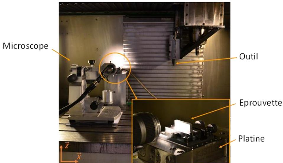
**Figure 1 : Dispositif expérimental avec système d'observation.**
