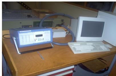
Figure N° 5 Equipements d'acquisition des forces
