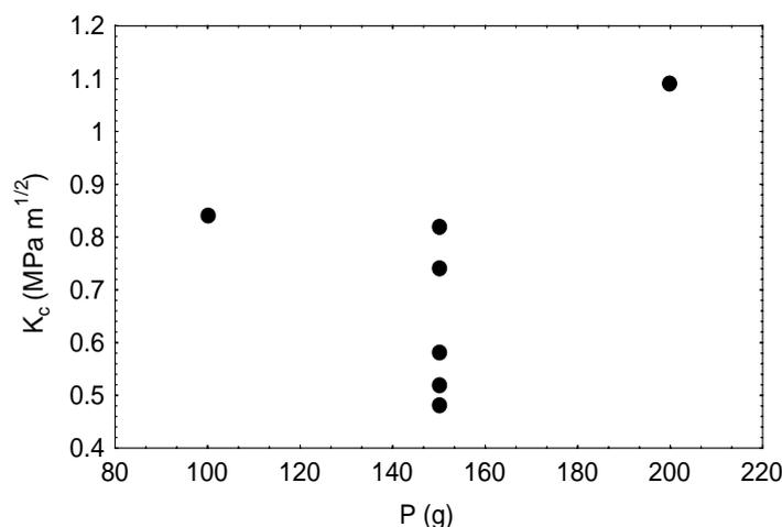
Figure 7 : Evolution de la ténacité (calculée en utilisant la formule d'Evans et Charles) d'un revêtement d'HAP en fonction de la charge appliquée. La longueur des fissures a été estimée en appliquant la méthode de Townsend et Field.
