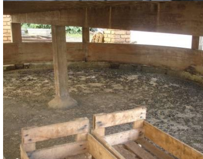
Figuras 50: A erva-mate é colocada na cancha para trituração. O rolete cônico dentado era puxado por animais. O produto pronto cai pelos buracos até a parte inferior da cancha.
