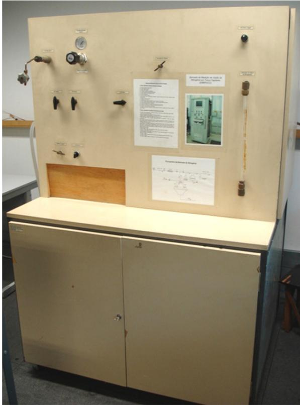
Figura V.2 - Bancada para medição da vazão de nitrogênio
