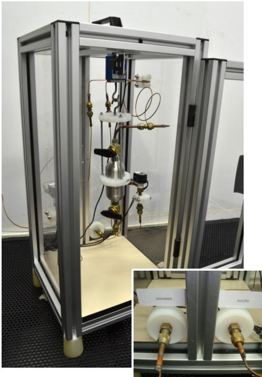
Figura 3.4 - Dispositivo de carga e conexões de sucção e descarga
