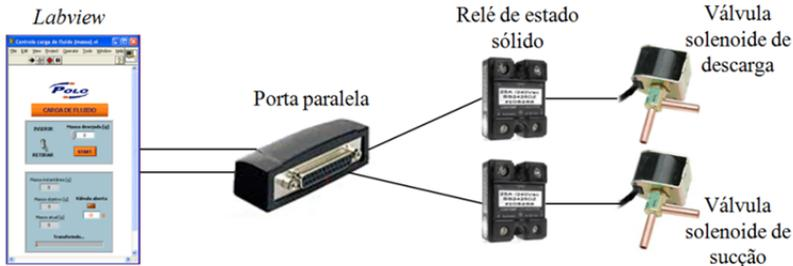
Figura 3.9 - Esquema de acionamento das válvulas solenoides do dispositivo de carga
