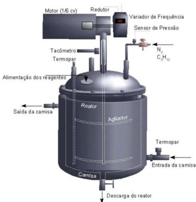
Figura 3.1 – Esquema do reator utilizado nas sínteses e impregnação de agente expander (Mazzuco 2001).
