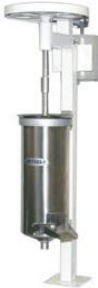
Figura 2. Despolpadora mecânica usada para extração da bebida dos frutos de Syagrus romanzoffiana utilizada nas análises físico-químicas, perfil de ácidos graxos, carotenóides totais, fenólicos totais e fibra alimentar.
