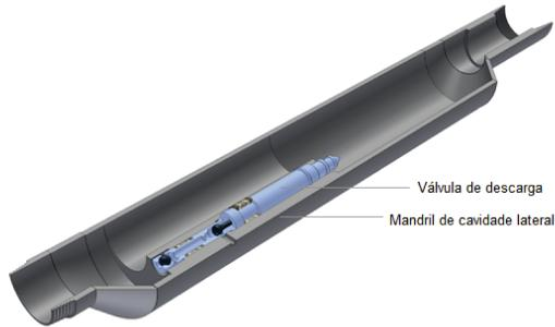
**Figura 2.6:** Localização da válvula de descarga no interior do mandril de cavidade lateral.
