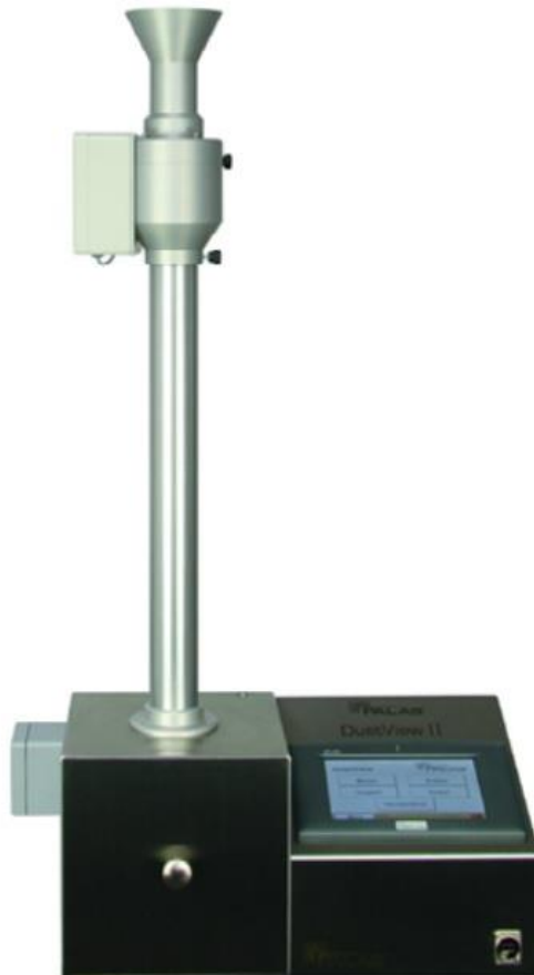
Figura 2.7 - Sistema de medição para formação de pó em queda livre e pó impactado, DustView [36].
