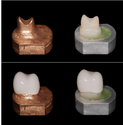
Fig 2. Suportes fabricados para as coroas durante os testes. Na direita, suportes de liga de cobre foram utilizados para o teste de compressão. Os suportes para o teste de fadiga foram feitos de resina composta e fixados com resina epóxi em um suporte de alumínio.
