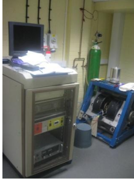
Fig. 2.11 – Suporte para amostras com aquecimento por efeito Joule e fluxo de argônio localizado entre as bobinas do magnetômetro.
