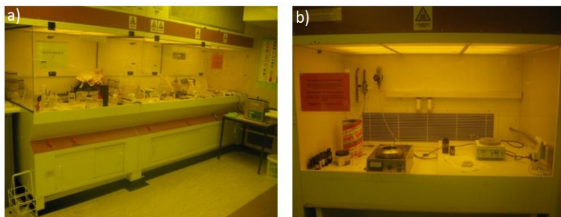
Fig. 2.7 – a) Capela para limpeza dos substratos e b) capela para realização de spincoating e softbake .
