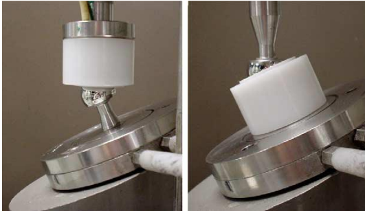
Figura 26 - Dispositivo simulador da articulação do quadril para ensaio de desgaste: (a) montagem anatômica (b) montagem invertida. Fonte: Affatato et al. (2008).
