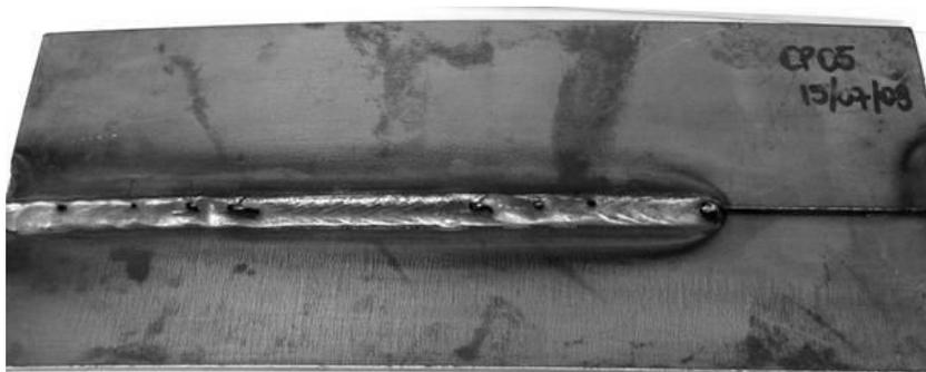
**Figura 43 - Resultado de soldagem usando o processo TIG em chapas de aço de 3 mm de espessura (Junta sobreposta; Velocidade de soldagem 45 cm/min; Gás de proteção: Argônio puro)**
