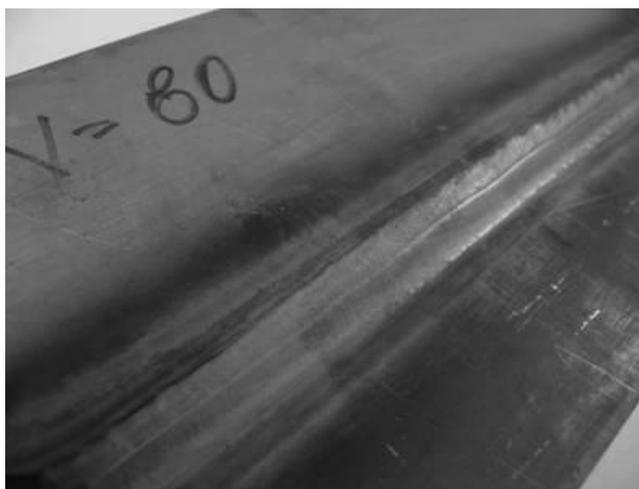
**Figura 44 - Resultado de soldagem usando o processo TIG em chapas de aço de 3 mm de espessura (Junta sobreposta; Velocidade de soldagem 80 cm/min; Gás de proteção: Ar + 8% $H_2$ )**
