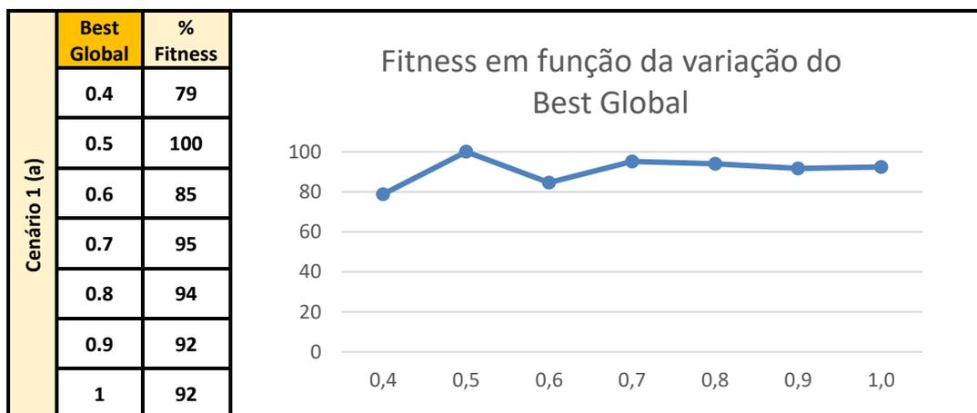
Figura 35 Dados e respectivo diagrama do comportamento da fitness do EPSO em função da variação do Best Global.
