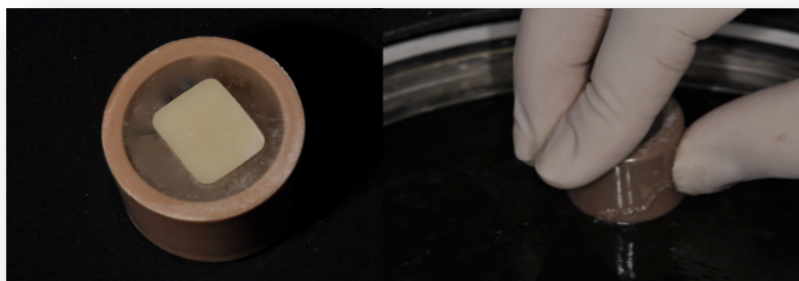
Figura 2 – Superfície cerâmica após a inclusão e polimento com lixas de Carbetto de Silício na politriz
