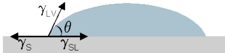
Figura 2.3 – Desenho esquemático do ângulo de contato \theta entre uma gota líquida e uma superfície plana e horizontal.
