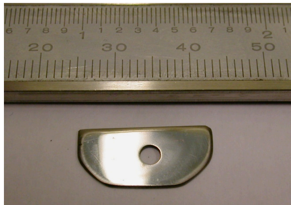
Figura 3.4 - Fixador confeccionado em aço SAE 1004 para auxílio na fixação dos grids.
