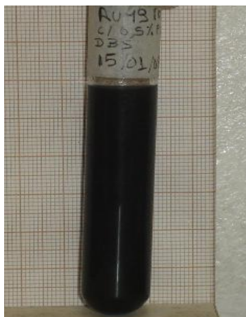
Figura 4.41. Foto da dispersão 04 com 0,5 % peso de aditivo no óleo PROECO ISO VG5-1.
