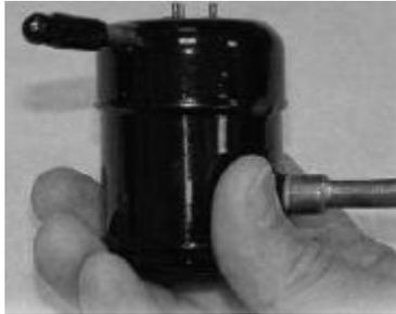
**Figura 2.3 – Protótipo do compressor de pistão rolante.**
