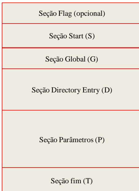
Figura 2.4. Estrutura geral de um arquivo IGES.
