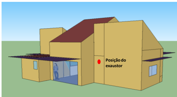
a) Posicionamento do exaustor na fachada Sul.
