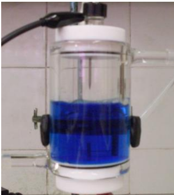
Figura 16: Vista lateral do reator de plasma frio (reator UFSC) para o tratamento de poluentes aquosos.
