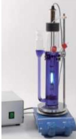
**Figura 6:** Reator utilizado na cinética de fotodegradação catalítica
