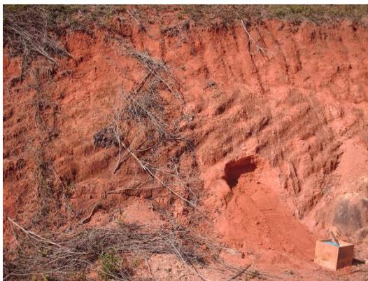
**Figura 67** – Coleta da amostra do solo A13, observando-se uma matriz granular, grosseira e rígida.
