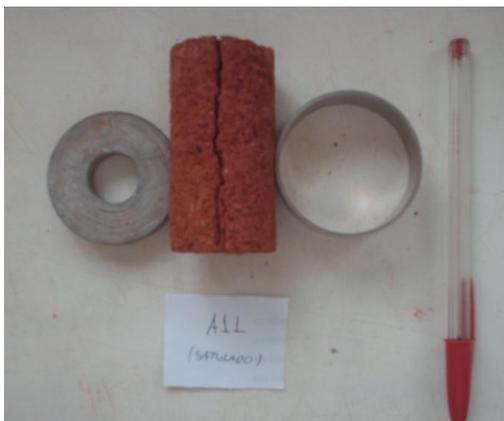
**Figura 60** – Solo A11 (amostras utilizadas na compressão diametral).
