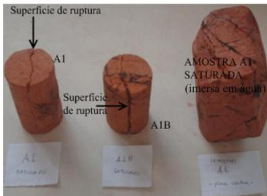
**Figura 108** – Visualização das superfícies de ruptura e da amostra A1, depois da imersão em água por 48horas, vista superior.
