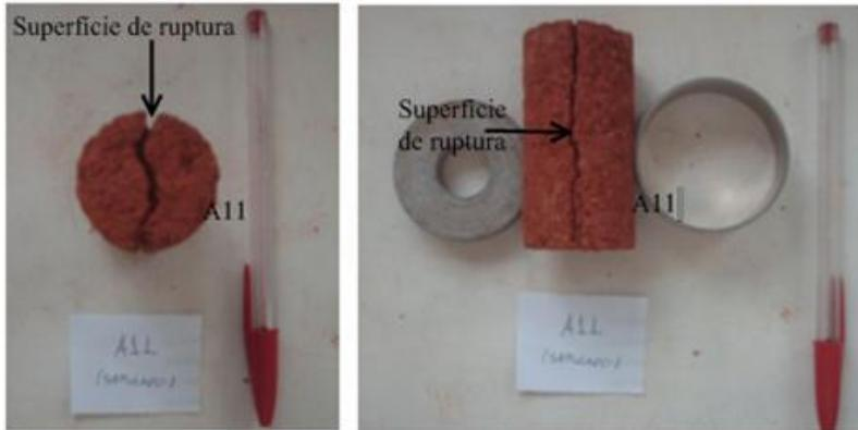
**Figura 110** – Visualização da superfície de ruptura para a amostra A11.
