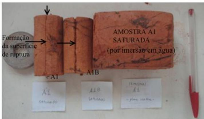
**Figura 109** – Visualização das superfícies de ruptura e da amostra A1, mantida em imersão durante 48horas, vista lateral.
