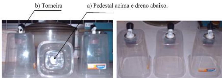
**Figura 78** – Recipientes coletores montados: Vista de topo (esquerda) e lateral (direita).
