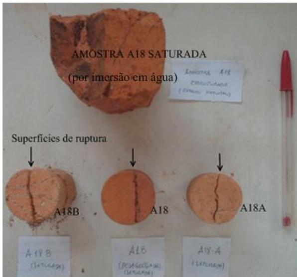
**Figura 111** – Vista de topo, das superfícies de ruptura do solo A18, e da amostra inundada (A18), depois da imersão por 48horas.
