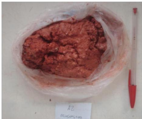
**Figura 119** – Amostra A2, que desagregou durante a imersão, apesar de ter sido selecionada.
