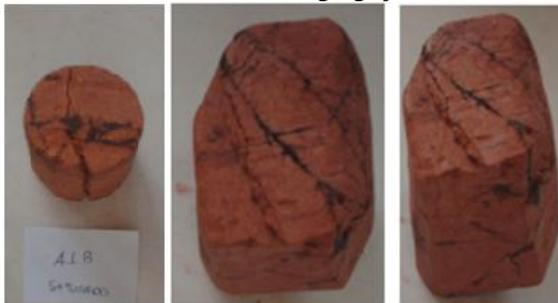
**Figura 48** – Foto do solo A1. Pode-se observar a distribuição dos planos aleatórios pela massa de solo bem acentuados.
