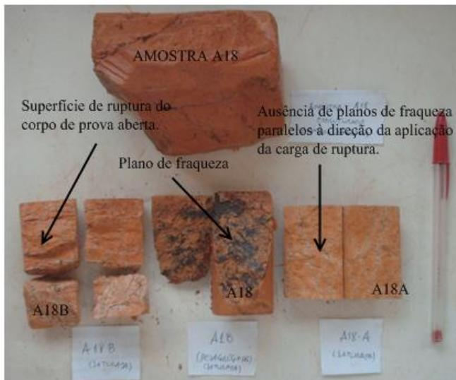
**Figura 113** – Visualização dos corpos de prova abertos, mostrando a presença de plano de fraqueza no corpo de prova A18, e ausência nos demais.
