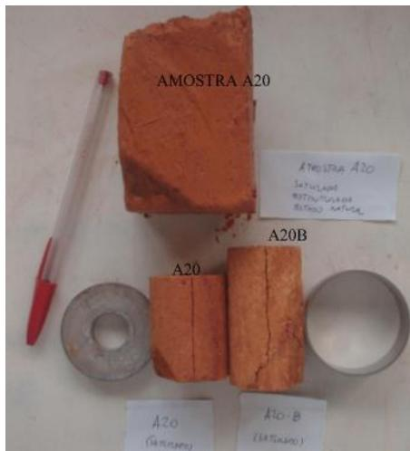
**Figura 117** – Visualização da superfície de ruptura ao longo do corpo de prova, vista lateral (A20).
