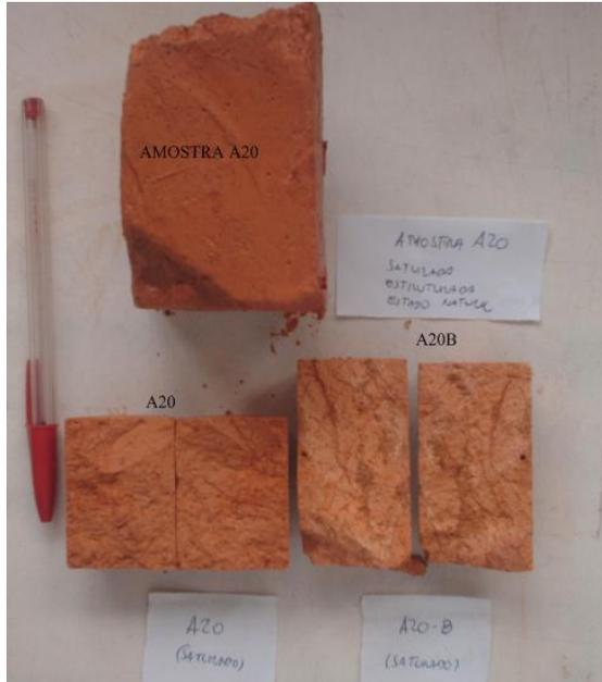
**Figura 118** – Corpos de prova abertos, mostrando ausência de planos de fraqueza (A20).
