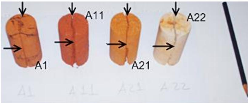
**Figura 103** – Visualização das superfícies de ruptura, vista superior (A1, A11, A21 e A22).
