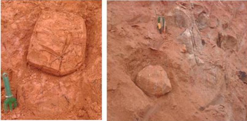
**Figura 35** – Amostragem de blocos indeformados dos solos A1 (esquerda) e região de amostragem dos solos A2, A8 e A9 (direita).
