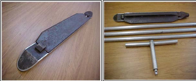
Figura 13 – Coletor Russo para amostras de turfa.
