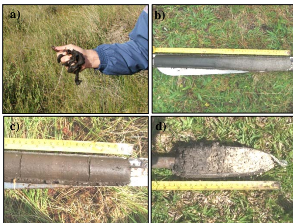
Figura 3 – Sequência de campo. a) teste do esmagamento realizado na base da turfa (catotelmo). b) testemunho da turfa: a parte mais escura representa o catotelmo, após esse ocorre material com tonalidades de cinza misturado com areia. c) continuação do testemunho: material de coloração marrom com restos vegetais. d) base do testemunho: muita areia e cascalho, próximos da rocha. Fotos: Marcelo A. T. de Oliveira, 2009.
