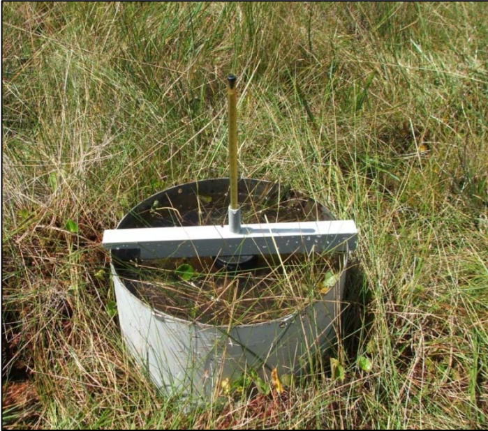
Foto 8 – Ensaio de infiltração pelo método do anel concêntrico.
