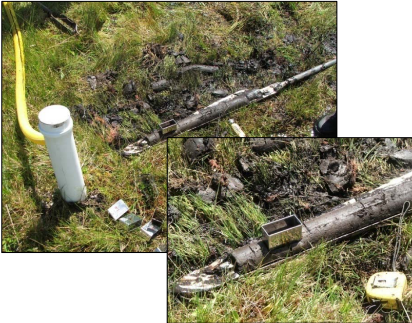
Foto 6 – Coleta de amostras em campo para a realização do teste de densidade real e aparente.
