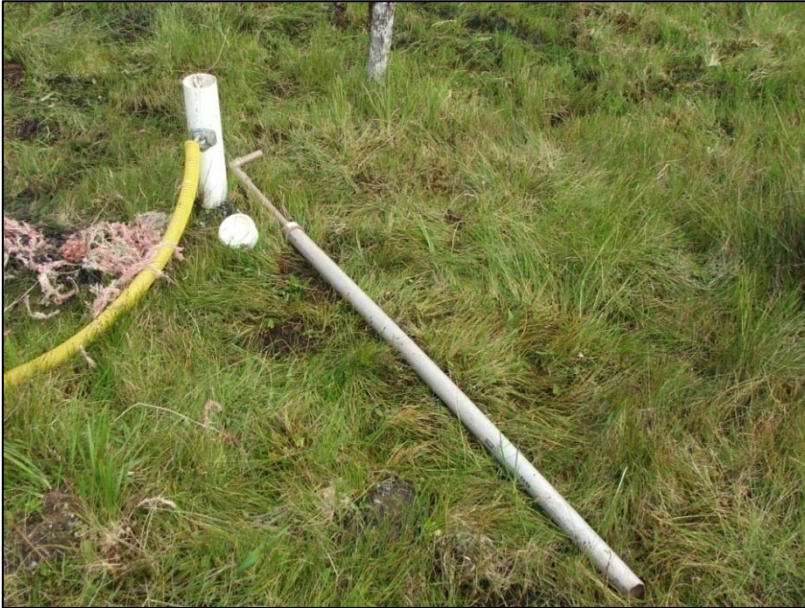
Foto 7 – Ensaio de recuperação, utilizando um sugador em um dos poços piezométricos.
