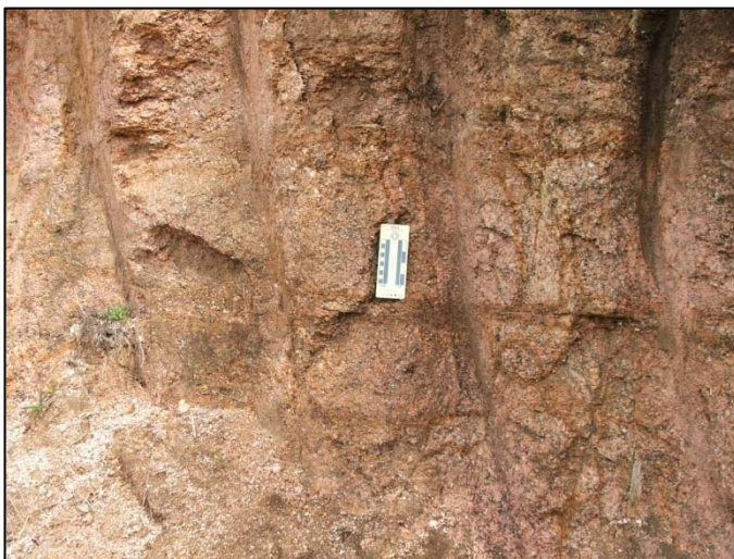
Foto 2 – Manto de alteração desenvolvido a partir do granito São Bonifácio encontrado ao longo da trilha de acesso ao Campo da Ciama.
