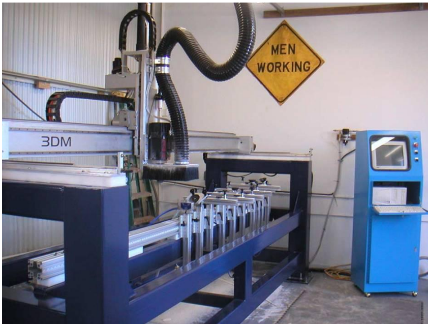
FIGURA 12 – A Máquina de cortar bloco.
