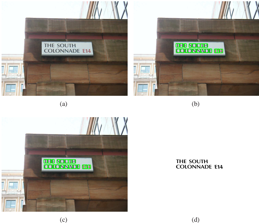
Fig. 5.12: Imagem-cena contendo caracteres em um plano de fundo texturizado. (a) Imagem original. (b) Resultado após as etapas de localização e verificação. (c) Desempenho do sistema sob método de avaliação mínimo BB. (d) Resultado da etapa de extração.
