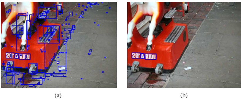
Fig. 3.29: Exemplos das etapas de localização e verificação. (a) Resultado da etapa de localização (anterior à etapa de verificação). (b) Resultado após a etapa de verificação proposta.
