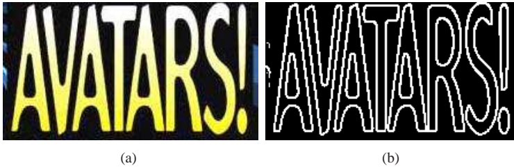
Fig. 1.7: Caracteres policromáticos e as bordas correspondentes. (a) Imagem com variação de cor no corpo do caractere (degradê entre o branco e o amarelo). (b) Bordas extraídas da imagem.
