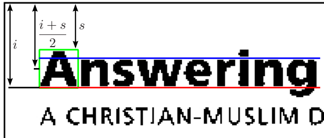
Fig. 5.2: Medidas extraídas de cada BB para a formação do vetor de clusterização.
