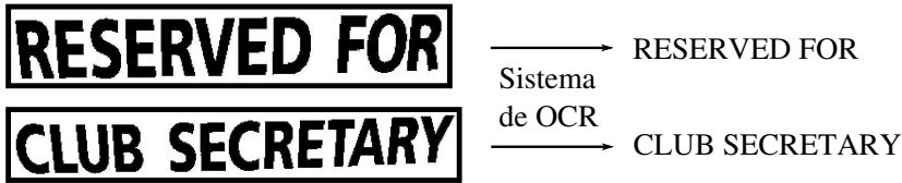
Fig. 1.12: Transformação da imagem binária contendo caracteres em texto plano (ASCII) (o lado esquerdo apresenta as regiões após a etapa de extração, enquanto o lado direito representa a saída do OCR).
