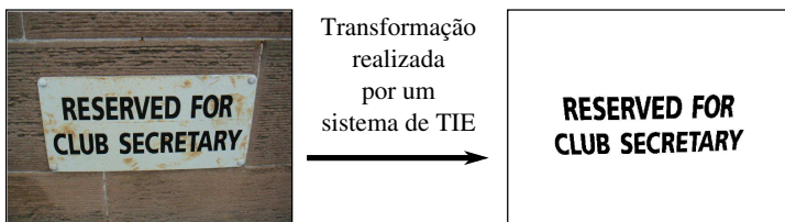
Fig. 1.9: Transformação realizada por um sistema TIE com o objetivo de separar os caracteres do plano de fundo complexo.
