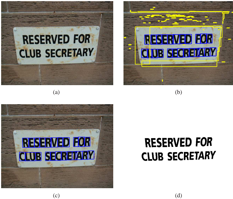
Fig. 1.11: Sequência de resultados das 3 primeiras etapas de um sistema TIE. (a) Imagem original. (b) Resultado da etapa de localização (BBs azuis representam os caracteres corretamente localizados, enquanto os BBs amarelos representam os falsos positivos). (c) Resultado após a etapa de verificação. (d) Imagem binária após a etapa de extração.
