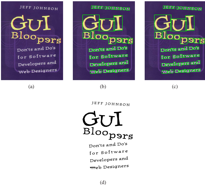
Fig. 5.21: Imagem-artificial contendo caracteres de variadas dimensões e orientações. (a) Imagem original. (b) Resultado após as etapas de localização e verificação. (c) Desempenho do sistema sob método de avaliação mínimo BB. (d) Resultado da etapa de extração.
