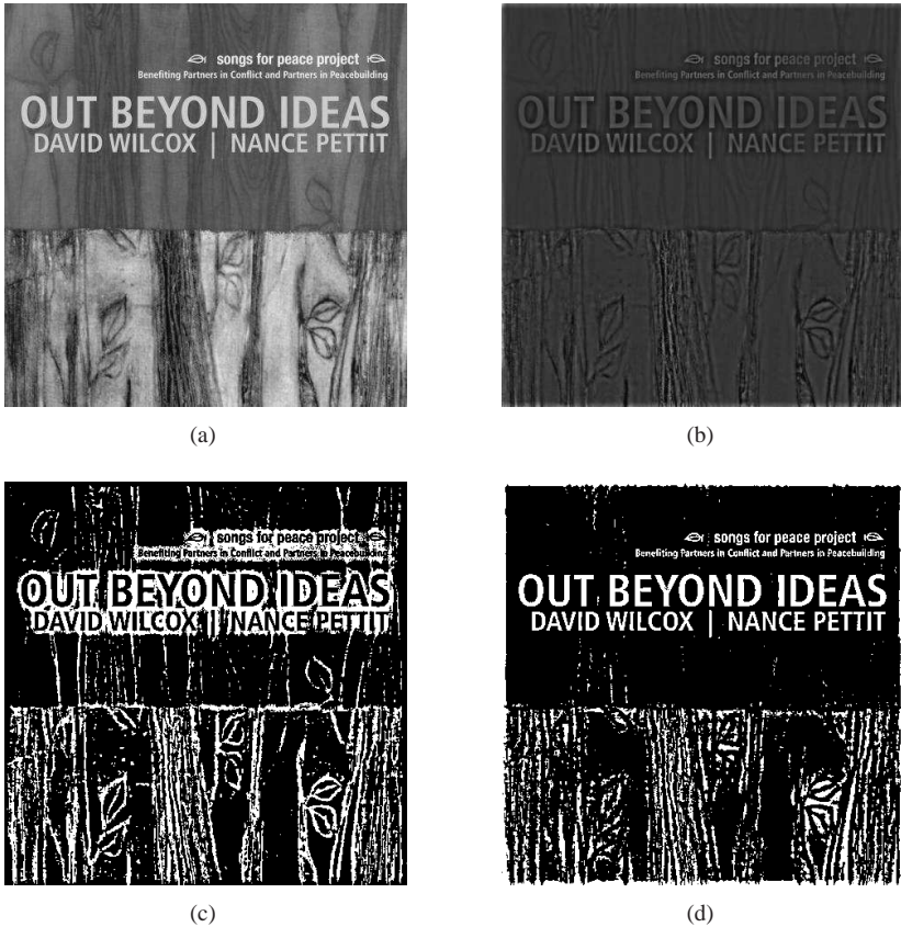
Fig. 2.4: Sequência de operações do método proposto por Messelodi e Modena. (a) Imagem em escala de cinzas original. (b) Imagem após a normalização da intensidade. (c) Imagem binária resultante da limiarização da imagem normalizada cujos pixels possuem níveis de cinza menores do que o limiar l_1 . (d) Imagem binária resultante da limiarização da imagem normalizada cujos pixels possuem níveis de cinza maiores do que o limiar l_2 .
