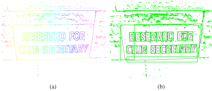
Fig. 2.17: Transformação de bordas candidatas a texto em CCs e delimitadas por BBs. (a) Imagem de bordas transformadas em CCs, em que cada CC está representado em uma cor. (b) Imagem de CCs delimitados por BBs.
