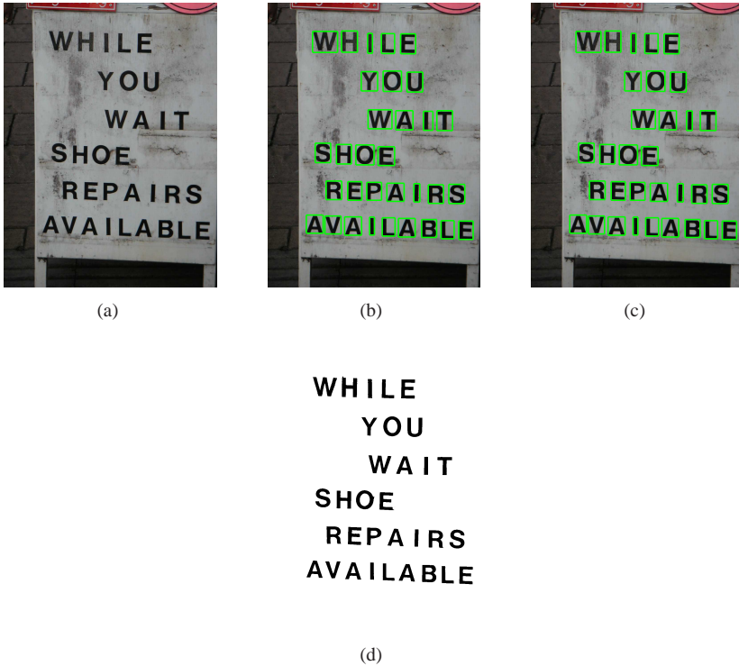
Fig. 5.23: Imagem-cena contendo caracteres apresentando contraste com o plano de fundo. (a) Imagem original. (b) Resultado após as etapas de localização e verificação. (c) Desempenho do sistema sob método de avaliação mínimo BB. (d) Resultado da etapa de extração.
