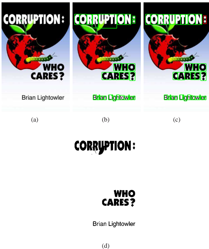
Fig. 5.28: Imagem-artificial contendo caracteres de contraste positivo e negativo. (a) Imagem original. (b) Resultado após as etapas de localização e verificação. (c) Desempenho do sistema sob método de avaliação mínimo BB. (d) Resultado da etapa de extração.
