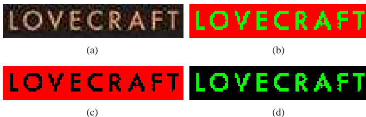
Fig. 4.10: Imagem-exemplo segmentada pelo método K-means recorrente. (a) Imagem original. (b) Imagem segmentada em duas regiões definidas pela clusterização da Fig. 4.9. Plano gerado pelo cluster referente à: (c) semente [036 034 035]; (d) semente [189 163 138].
