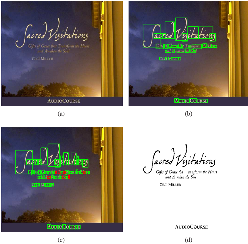
Fig. 5.13: Imagem-artificial contendo fontes possuindo ascendência e descendência, além de caracteres com tamanho reduzido. (a) Imagem original. (b) Resultado após as etapas de localização e verificação. (c) Desempenho do sistema sob método de avaliação mínimo BB. (d) Resultado da etapa de extração.
