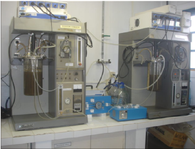
Figura 4.3 - Reator 1 (R1) e Reator 2 (R2) sendo operados simultaneamente.
