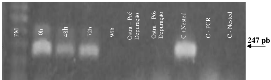
Figura 1.5: Eletroforese em gel de agarose 1,5 % de produtos de nested PCR referentes à depuração em sistema fechado. A: Adenovirus; B: vírus da Hepatite A; PM: marcador de peso molecular 100pb
