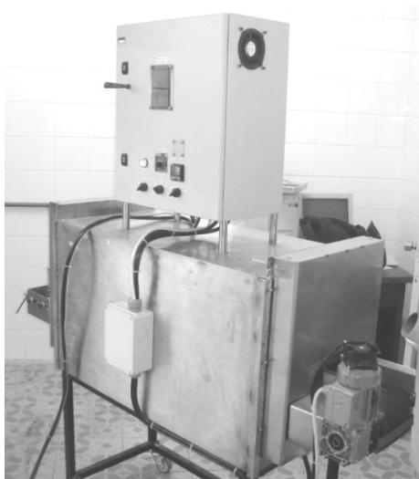
Figura 3.2 Forno esteira estudado para o sapeco da erva-mate
