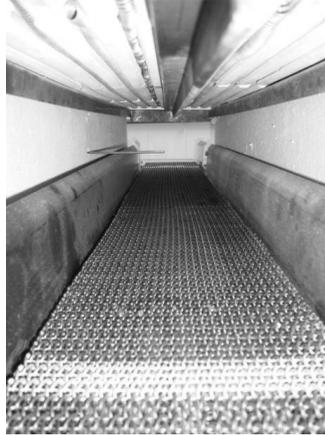
Figura 3.3 Esteira transportadora do forno esteira
