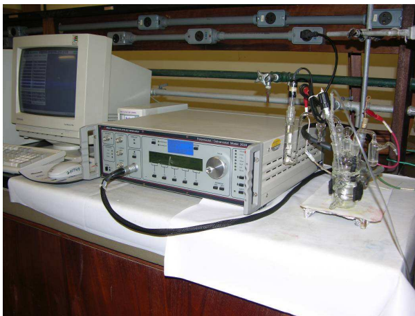
Figura 11. Fotografia da célula eletroquímica e equipamento utilizado nos experimentos de polarização potenciodinâmica e voltametria cíclica.
