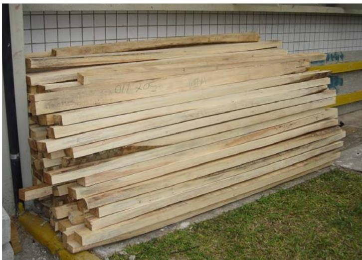
**Figura 15 - Peças desclassificadas devido aos defeitos e ao pouco aproveitamento.**
