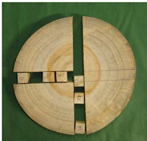
**Figura 29 - Posição dos corpos de prova em relação ao disco de madeira.**
