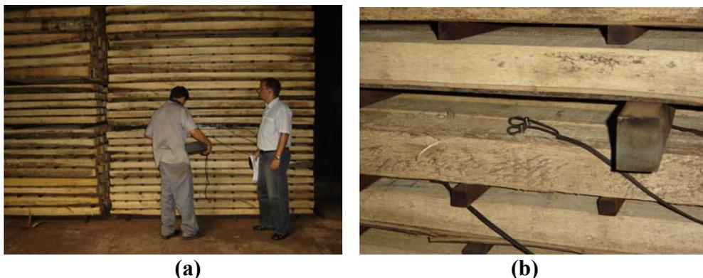
**Figura 13 – Secagem da madeira: (a) determinação do teor de umidade com higrômetro resistivo portátil e (b) higrômetro resistivo do sistema controlador da estufa.**
