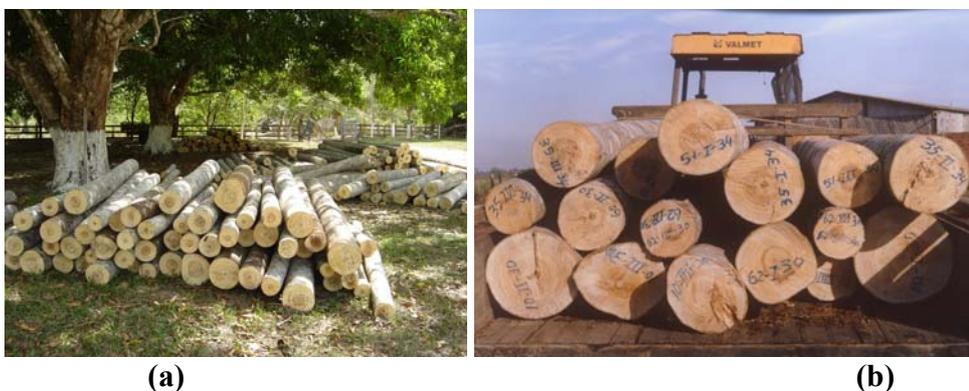
**Figura 9 - (a) Toretos codificados e armazenados conforme idade e (b) toretos codificados sendo transportados para desdobro.**
