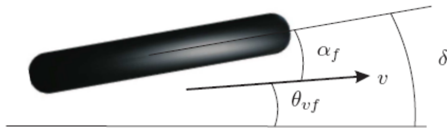
Figura 11: Ângulos das rodas frontais.
