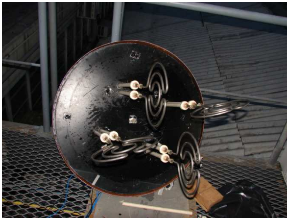
Figura 4.12 – Vista da parte inferior da tampa do termoacumulador com a montagem das resistências elétricas.
