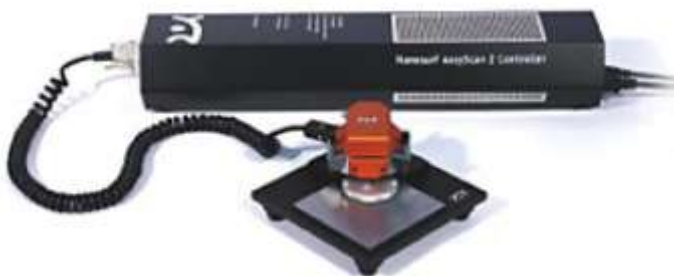
Figura 13: AFM Nanosurf Easyscan 2,0 utilizado nas medidas de morfologia e espessura.
