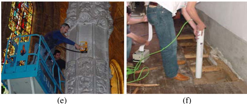
Figura 8: (a) exemplos de ensaios não-destrutivos realizados pela Universidade do Minho: micro-perfuração em tijolo, pedra e argamassa; (b) ensaios sônicos e ultrassônicos; (c) macacos-planos; (d) monitorização e identificação dinâmica; (e) georradar; (f) micro-perfuração em madeira.
