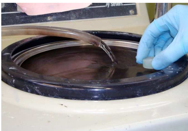
Figura 14: Superfície dental sendo desgastada em politriz, sob refrigeração a água, utilizando-se lixas de carbetto de silício.
