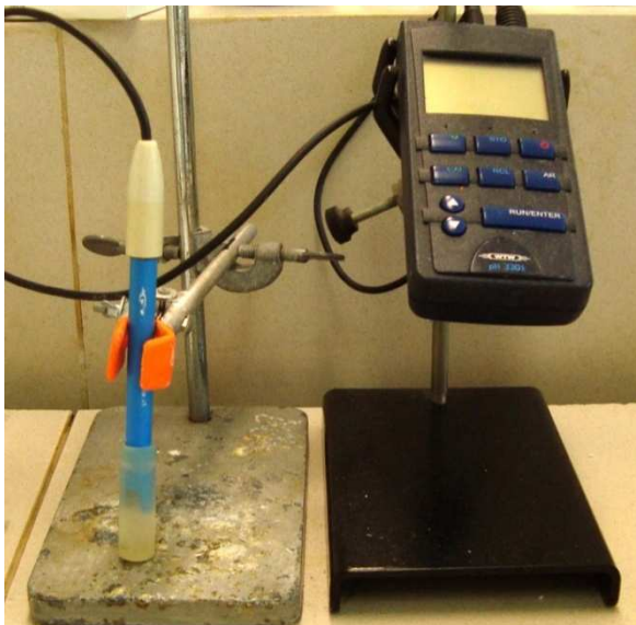
Figura 29: pHgâmetro pH 330i WTW com respectivo eletrodo utilizado na pesquisa.
