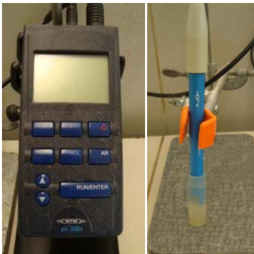
Figura 6- pHmetro pH 330i WTW com respectivo eletrodo utilizado na pesquisa.
