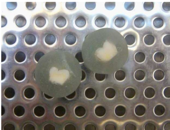
Figura 17: Corpos-de-prova em cuba ultrassônica com água destilada.
