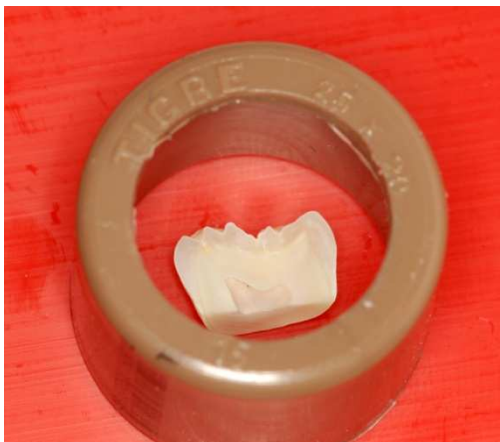
Figura 9: Fragmento da coroa dental fixado em lâmina de cera 7 e circundado por tubo de PVC.
