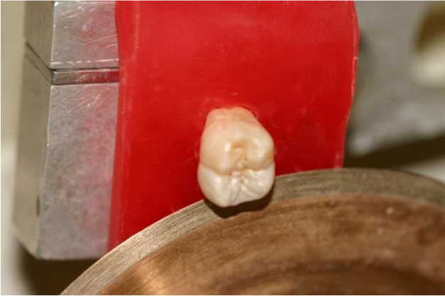
Figura 3: Dente fixo com cera pegajosa ao dispositivo da máquina de cortes, para o seccionamento da raiz no limite amelo-cementário.
