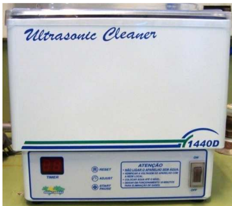
Figura 16: Cuba ultrassônica utilizada para limpeza das amostras.
