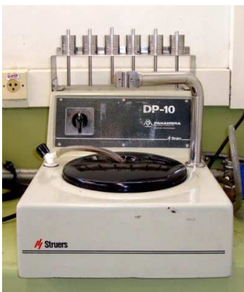
Figura 13: Politriz elétrica para desgaste e polimento das amostras.
