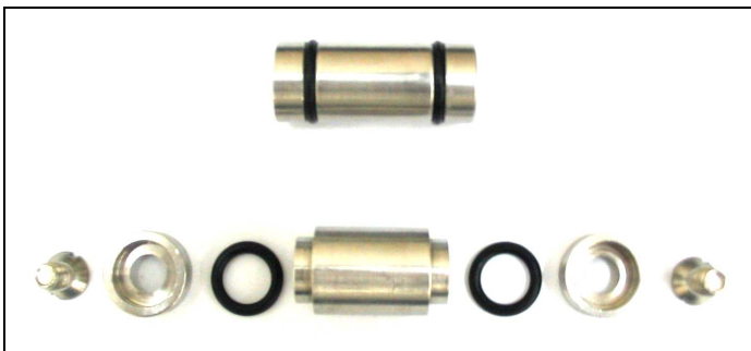
Figura 4: Pistão utilizado na célula de equilíbrio (LANZA, 2004).
