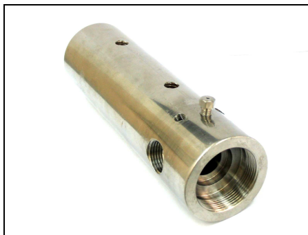
Figura 11: Célula de equilíbrio de volume variável. Fonte: (LANZA, 2004).
