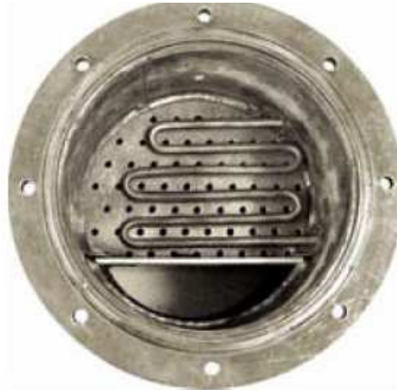
Figura 6.18 Disposição da Resistência sobre a superfície do prato na Unidade Piloto de Destilação.
