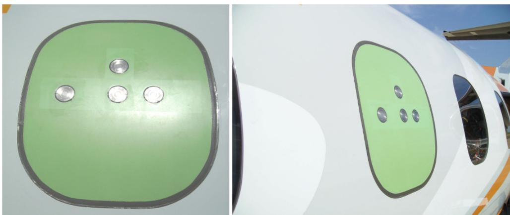
Figura 4.4 – Fotos da montagem dos microfones e janela metálica.
